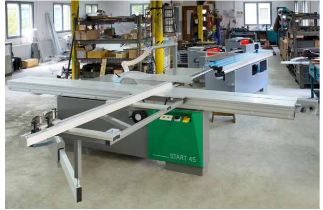
Formátovací pila PF 300L se zalíbila německému výrobci Altendorf, pro kterou ji firma ROJEK od loňského roku vyrábí v zelenošedém provedení s označením START 45
